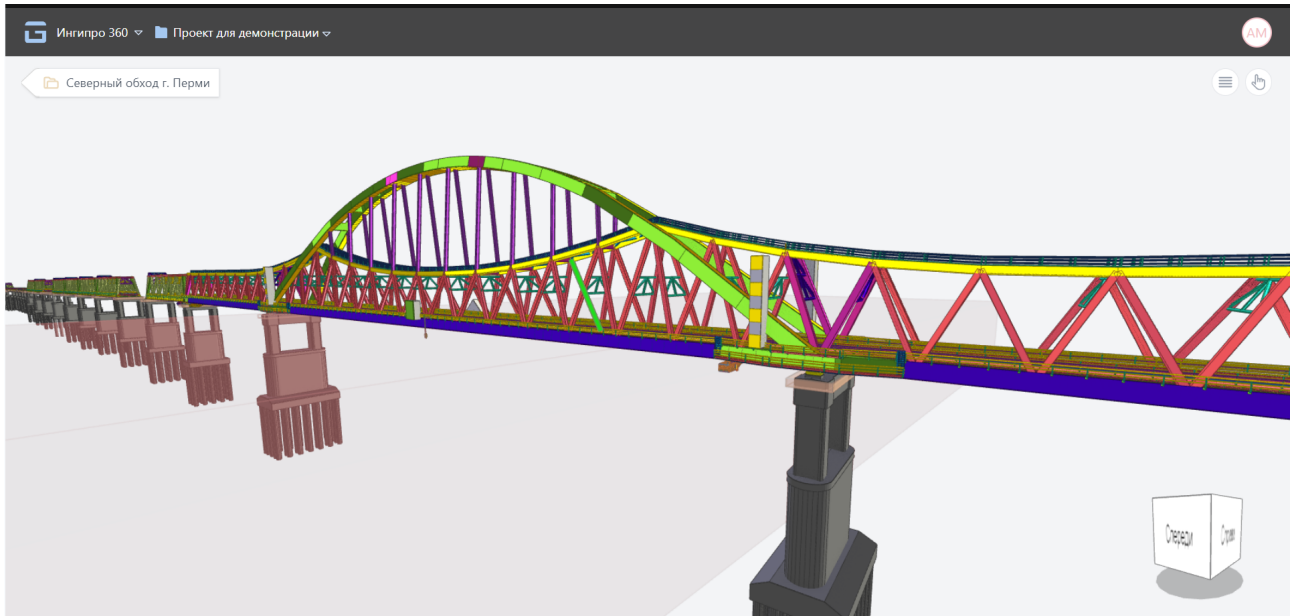
Рисунок 8. Пример открытия в web-интерфейсе браузера междисциплинарной сводной 3D-модели в российской СОД
