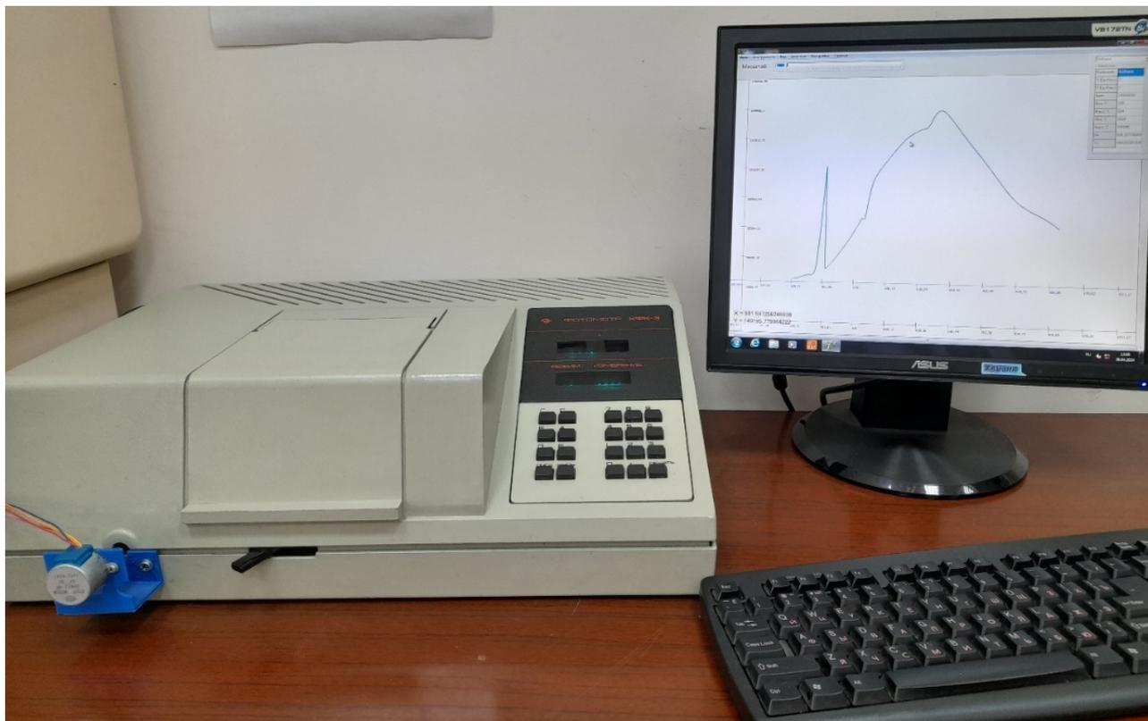
Рисунок 3. Внешний вид модифицированного фотометра
