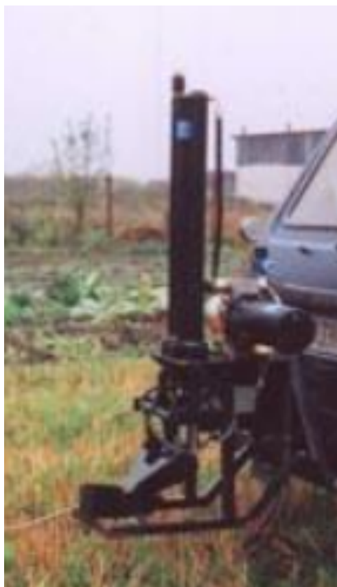
Рисунок 2. Автоматический пробоотборник, установленный на раму автомобиля
